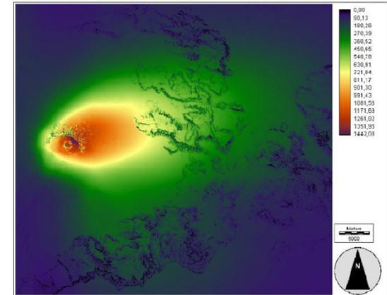
Log di conducibilità idraulica (K<sub>sat</sub>) della coltre piroclastica
